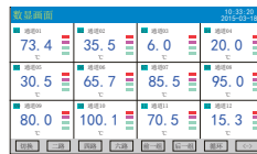
数显画面：显示实时测量值，同时还显示通道位号、工程单位及报警状态等信息
