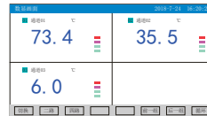
数显画面：显示实时测量值，同时还可显示通道位号、工程单位及报警状态等信息
