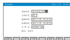
备份画面：可通过设定起始时间和结束时间来备份这段时间的数据
