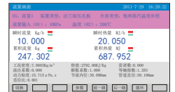
流量画面：将流量回路里的流量、温度、压力信息以组合的方式显示在同一画面上，同时显示各参数信息
