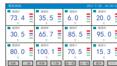
数字画面：显示实时测量值，同时还可显示通道位号、工程单位及报警状态等信息
