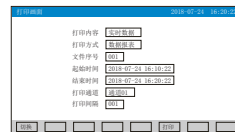
打印画面：可打印实时数据和历史数据，通过设定起始时间和结束时间来打印历史曲线和数据
