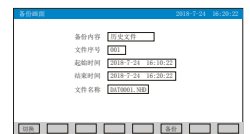
备份画面：可通过设定起始时间和结束时间来备份这段时间的数据
