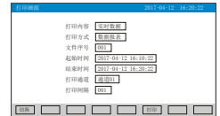
打印画面：可通过设定起始时间和结束时间来打印这段时间的曲线和数据
