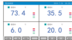
数字画面: 显示实时测量值, 同时还显示通道号、工程单位及报警状态等信息
