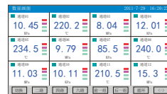
数显画面:显示实时测量值,同时还可显示通道号、工程单位及报警状态等信息
