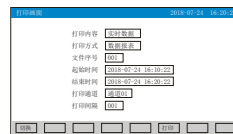
打印画面：可打印实时数据和历史数据，通过设定起始时间和结束时间来打印历史曲线和数据
